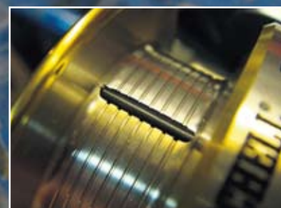
Gumminoppen auf dem Spulenkern, damit Geflochtene dicht durchrutscht
